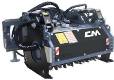
La fresadora en frío autonivelante Serie FS se utiliza para desmantelar las capas de pavimentos de carreteras o de cemento, para rasgar rocas o simplemente para crear cruces o trazas en lugares pavimentados. Se produce en 8 modelos con anchuras de 25 a 100 cm y se puede aplicar a cargadoras compactas, retroexcavadoras y cargadoras de ruedas hidrostáticas.
